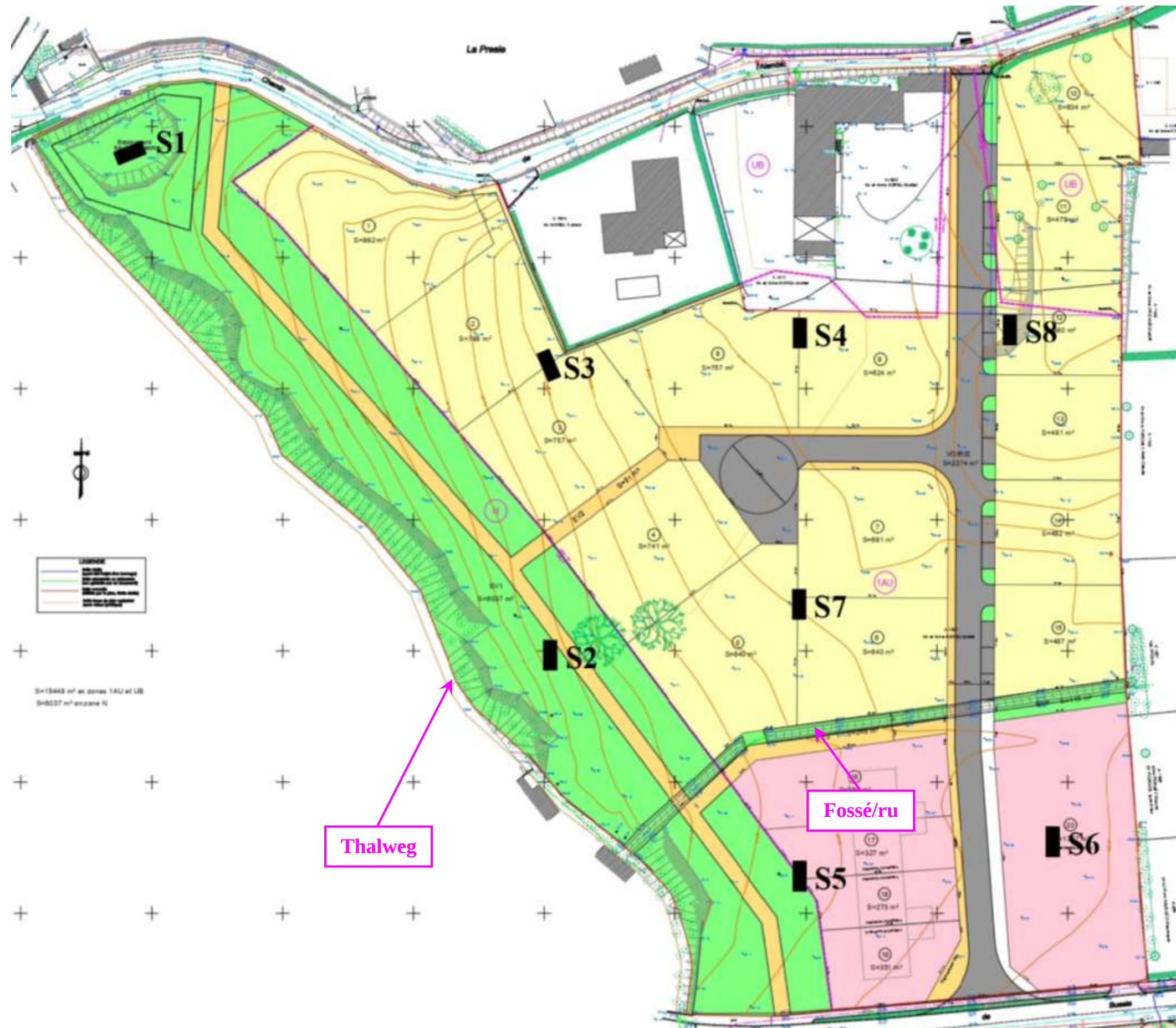
Fig. 7 – PLAN DE COMPOSITION & IMPLANTATION DES SONDAGES - ECHELLE : 1/800 me
